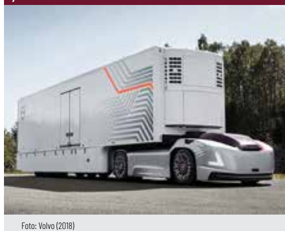
Figura 2-4 Vera: el camión autónomo y eléctrico de Volvo
